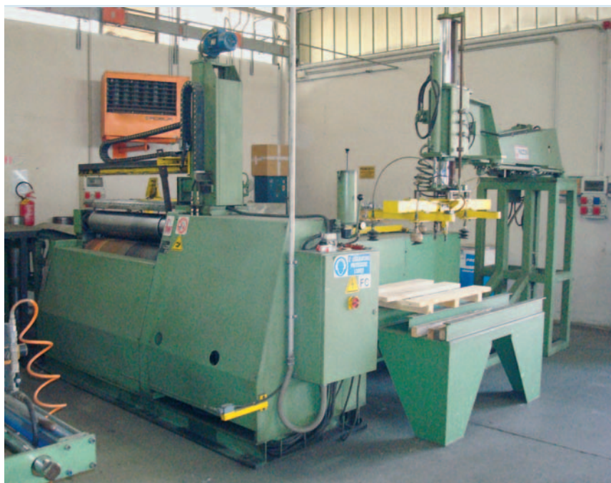
L'impianto di calandratura installato presso l'unità produttiva di Lodi
